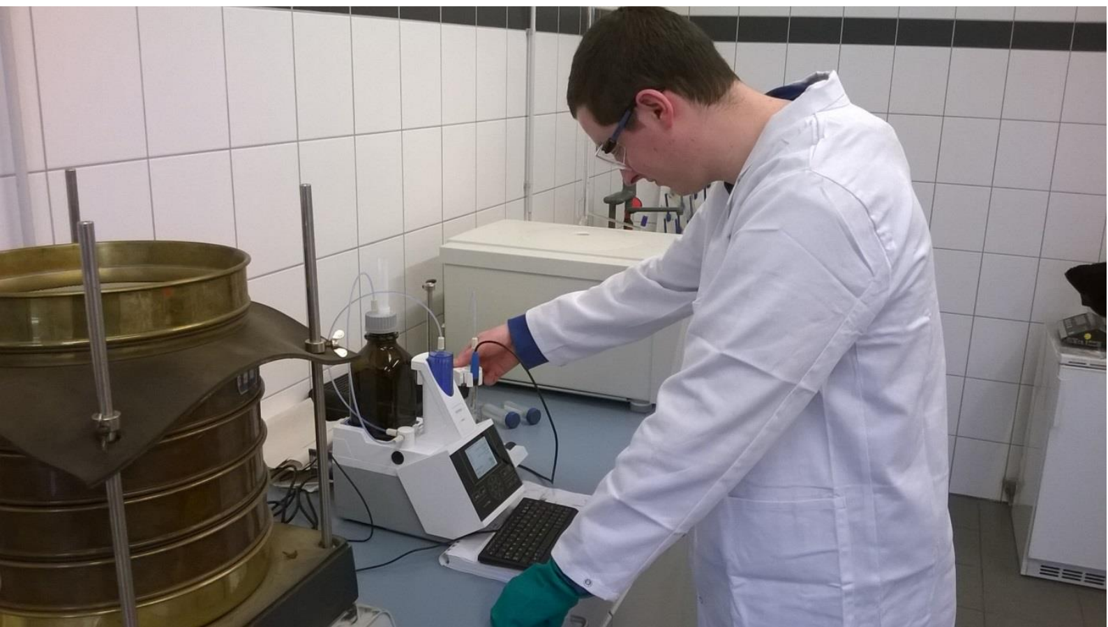
Labor-Analyse: Messung von FOS/TAC-Werten
